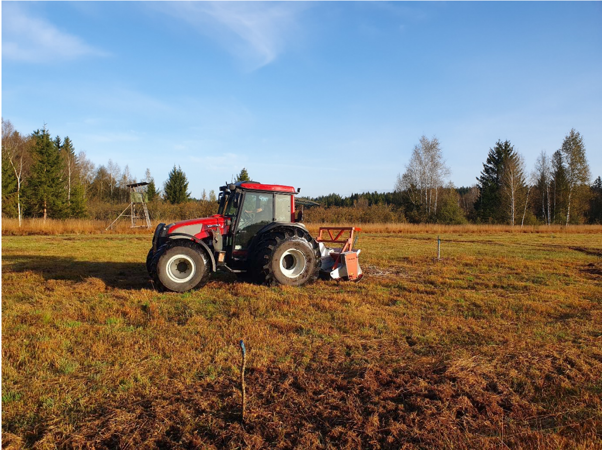
Abb. 4: Fräsen einzelner Wurzelstöcke damit zukünftig mit einem insektenschonenden Messermähwerk gemäht werden kann. Die Wurzelstöcke wurden mit einem blauen Stab markiert (Foto Haupt).
