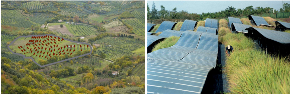
Abbildung 39: Integrativer Gestaltungsansatz von APV-Anlagen. (a) Mosaik-Anordnung angepasst an natürliches Landschaftsbild, (b) Bodennahe Anlagen, die der natürlichen Linienstruktur der Landschaft folgen (Scognamiglio, 2015).
