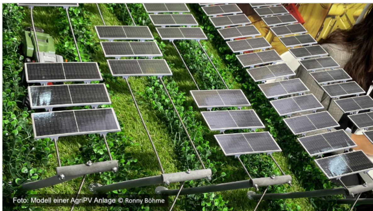
Abbildung 23: Modell einer Seilkonstruktion mit ‚Tracking‘-Funktion für eine APV-Anlage in Sachsen (VEE Sachsen e.V., 2022).
