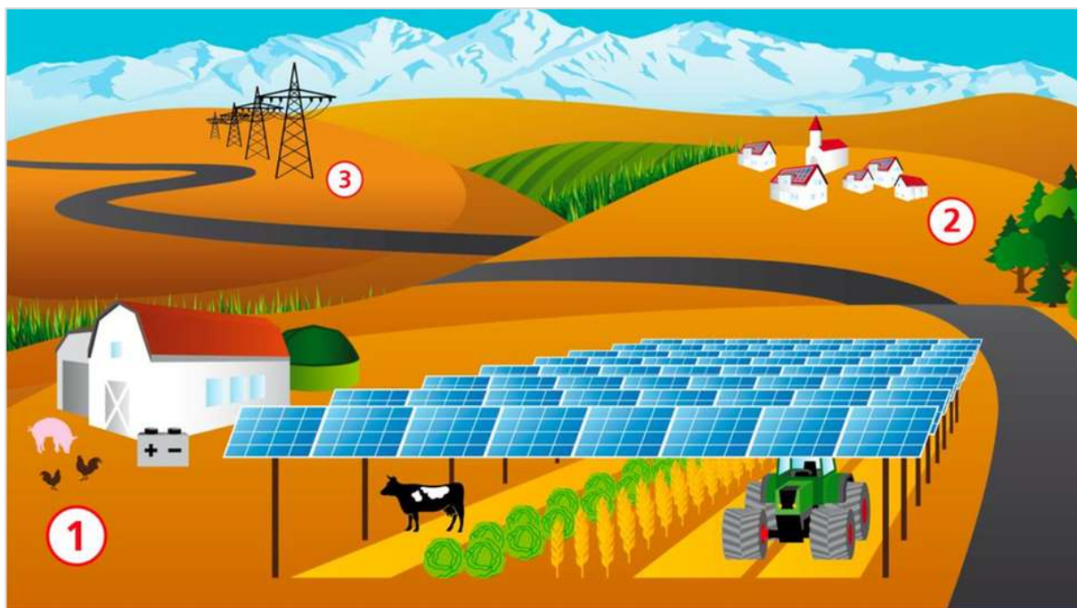
Abbildung 42: Nutzungsmöglichkeit des Stroms einer APV-Anlage: (1) Technischer Eigenverbrauch (mit Speicher), (2) Direktvermarktung an naheliegende Wohnsiedlung, (3) Energieeinspeisung ins Stromnetz (Trommsdorff et al., 2020).
